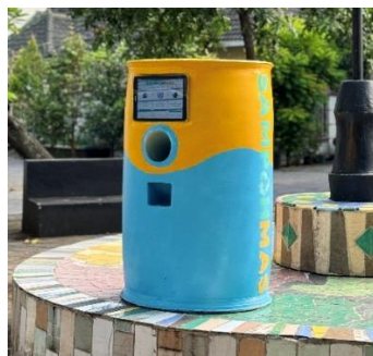
Gambar 14. Prototipe RVM dengan Layar dan IoT
