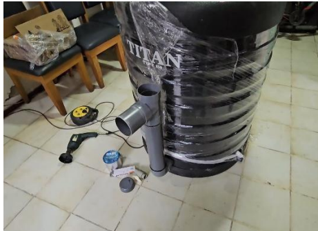
Gambar 4. Proses Pembuatan Modifikasi Biogas Digester
