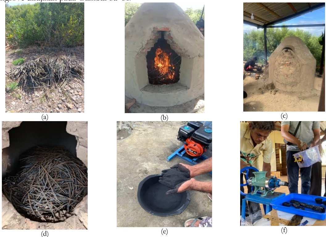
Gambar 3. Tahapan pembuatan briket. (a) Pengumpulan limbah propagul (b) pembakaran dapur arang (c) penutupan dapur arang (d) arang propagul (e) penghalusan arang propagul (f) pencetakan briket
