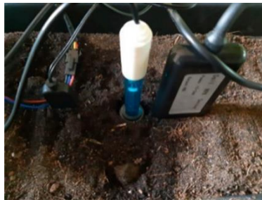
Gambar 8. Setup Pemasangan Sensor Pengukuran Lahan
