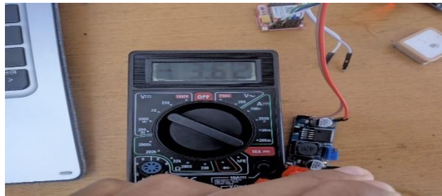
Gambar 5. Tampilan tegangan pengujian modul step down
